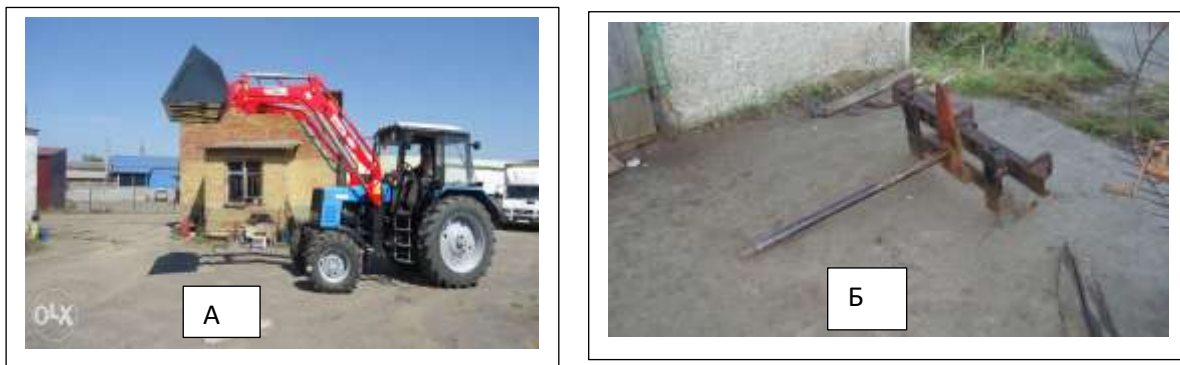
Рис. 4.3. Завантаження зерна у вантажний автомобіль за допомогою навісного обладнання до трактора з ківшом (А), а рулонів соломи – спец. штирем (Б)
