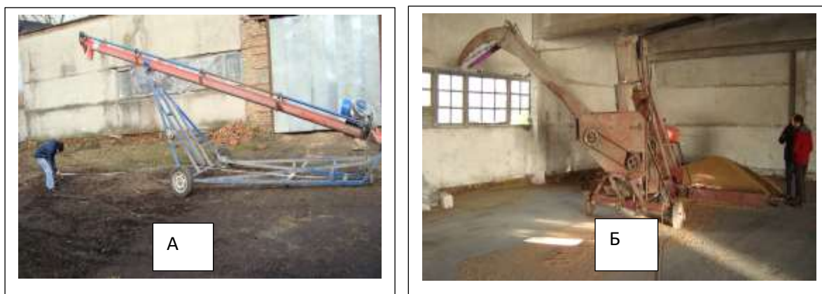
Рис. 4.1. Завантаження зерна у вантажний автомобіль гвинтовим перевантажувачем (А) за допомогою зерномета (Б)
