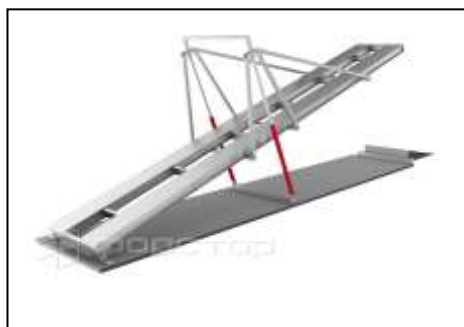
Рис. 2.3. Авторозвантажувач універсальний для зерносховищ та елеваторів
