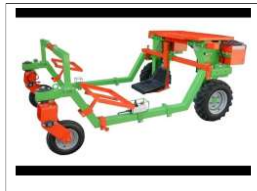
Рис. 8.1. Збір полуниці (А) і платформа-велосипед для збору ягід (Б)
